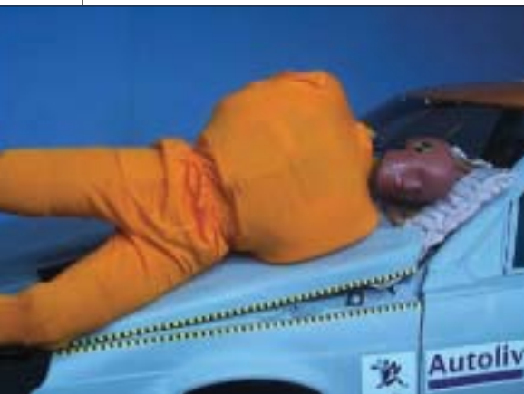
▲ En quelques millisecondes, des airbags sous le capot peuvent sauver des vies en créant une zone tendre de plusieurs centimètres.
